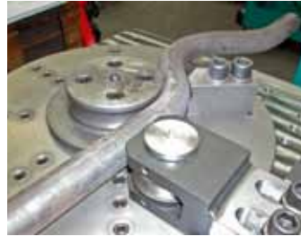
88 Rundstahl biegen bis ø 50 mm Round steel up to ø50 mm
