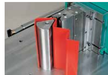
101 Dünnblech biegen Bending light sheet
