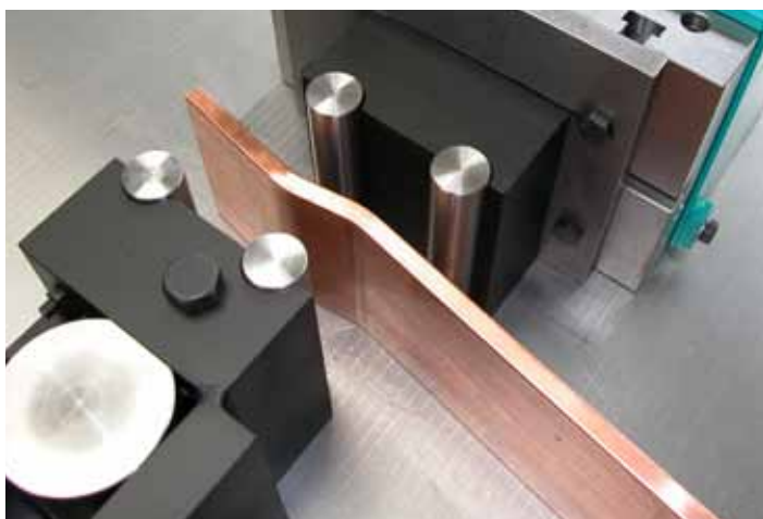
201 Absetzwerkzeug Step forming tool
