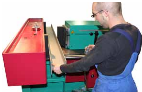
183 Richten mit der Hand- Fernbedienung Straightening with the hand remote control
