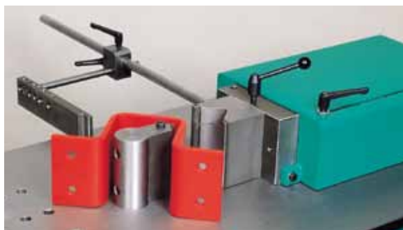
184 Zweiachsig einstellbarer Anschlag "M600" mit Skala Two-axis adjustable back gauge "M600" with scale
