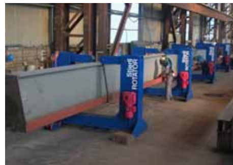
314 Mehrere Rotatoren für sehr lange Teile Several Rotators for very long parts
