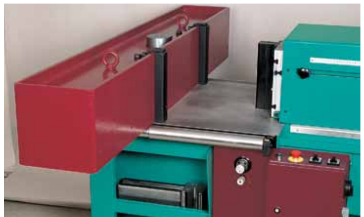
162 Richten bis HEA 260 Straightening up to HEA 260
