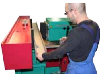
105 Richten mit Richtkabel Straightening with hand cable
