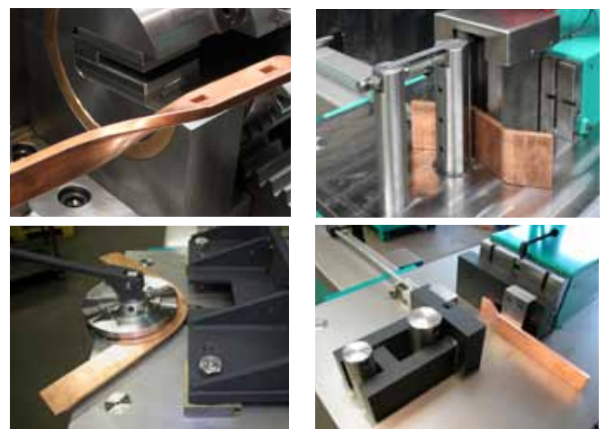
211 Starke Werkzeuglösungen: Hochkantbiegen, Verdrehen, Absetzen Strong tooling solutions: Edgewise bending, twist bending, step bending
