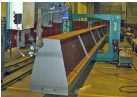
316 ROTATOR mit Schweissroboter kombiniert In Combination with welding robot
