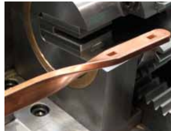
72 Verdrehwerkzeug 90° Torsion tool 90°
