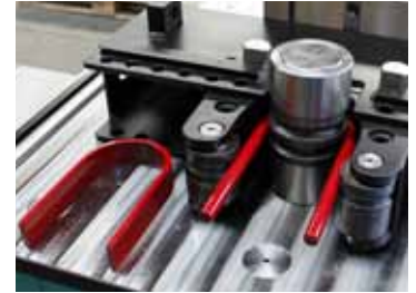
89 Horizontal biegen bis 180° Horizontal bending up to 180°
