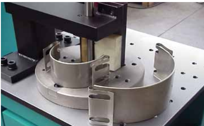
233 Dünnwandige und hohe Profile biegen Thin-plate and high profiles bending
