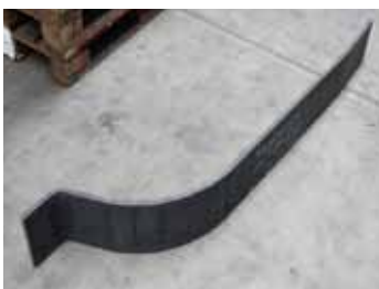
82 Lange Teile biegen (Untergurt) Long parts bending (beam flange)
