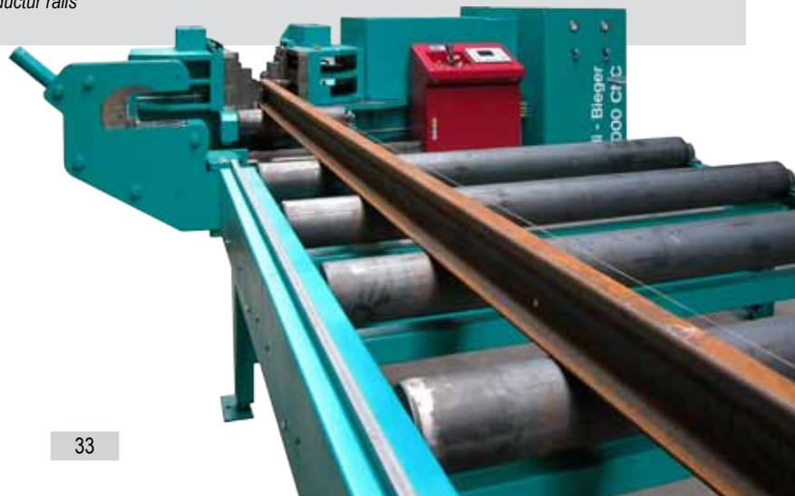
336 Torsion richten Torsion straightening
