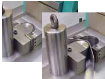
91 Formbiegen von Rohrschellen Form bending of pipe clamps
