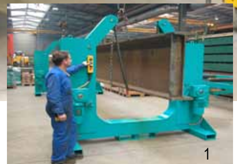
301 Träger absenken Lower the beam
