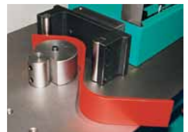
85 Biegen von grossen Radien Large radius bending
