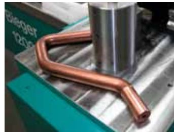
76 Grosse ø Durchmesser biegen Bending of huge ø diameters
