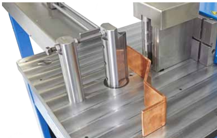
210 Prisma mit integriertem Messsystem für automatisches Nachbiegen Vee-block with integrated measuring system for automatic re-bend
