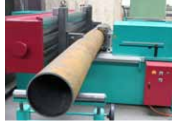
113 Rohre biegen/richten bis ø 400 mm Pipe bending/straightening ø400mm
