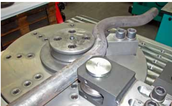
253 Standard Tischaufbau mit Gegenhalter, Mitnehmer und Biegebolzen Standard base with bending roll, driver and bending bolt
