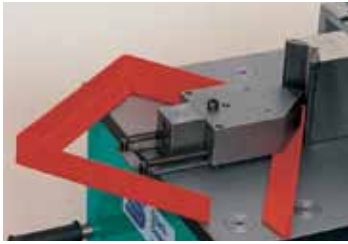
111 Rahmen biegen statt schweißen Frame bending instead of welding
