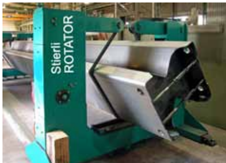
311 Erdungsanschluss durch die Kette Chain with integrated earth connection
