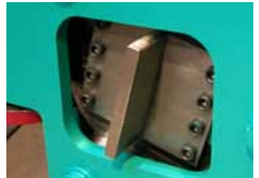
118 Torsion Richteinheit Torsion straightening device
