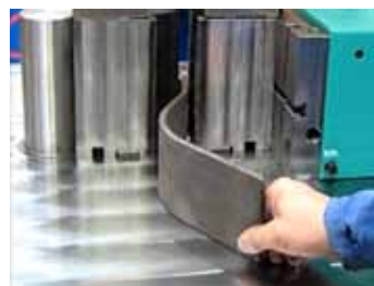
84 2-seitiges Biegen ohne Wenden 2-side bending without turning
