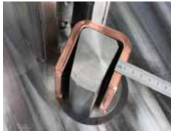
71 Enge Biegungen m. Sonderstempel Narrow section punch
